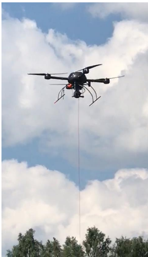
Подъемная платформа с полезной нагрузкой, бортовым преобразователем и кабелем питания
